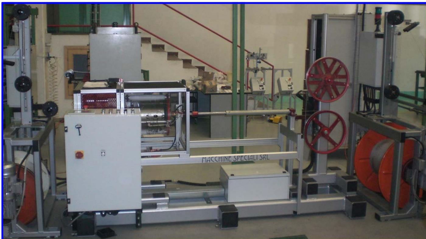
La ligne, composée par dérouleurs, tête à enrubanner concentrique, volant et enrouleur peut être utilisée pour enrubanner câbles jusqu'à 10 mm de diamètre. Toute la ligne est contrôlée par digital bus pour la synchronisation de tous les moteurs et actionnements. Tous les paramètres de tir du ruban peuvent être gérés avec des recettes imposées de touch screen.
